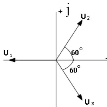
Рис. 2. Векторная диаграмма фазовых напряжений
