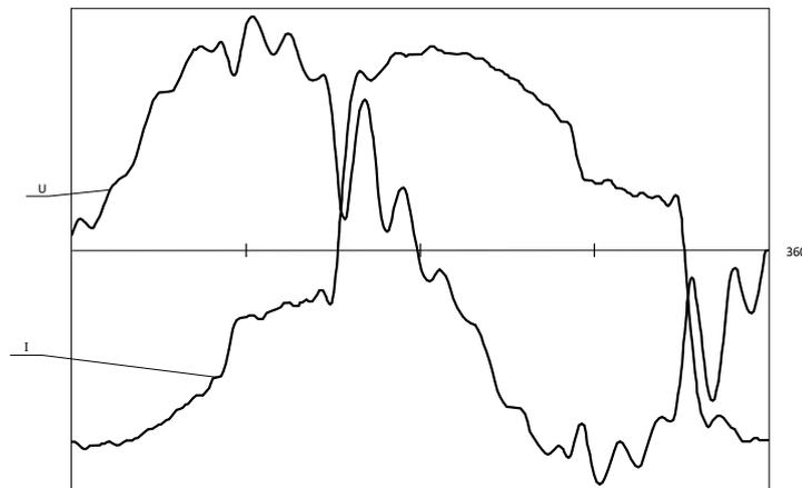
**Вариант 3** кривая напряжения шины 35кВ, максимальный ток 35 А (Верхняя кривая-напряжение)
