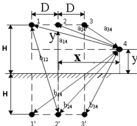
Рис. 1. Схема для расчета потенциала в точке 4
